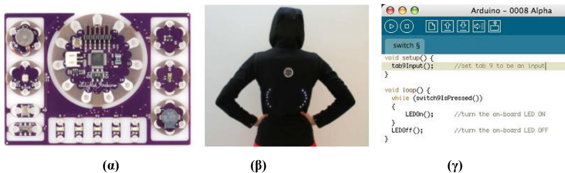
Εικόνα 4 (α) Η πλακέτα ανάπτυξης του LilyPad (β) LilyPad ενσωματωμένο σε μπλούζα (γ) Το περιβάλλον ανάπτυξης εφαρμογών Arduino.
